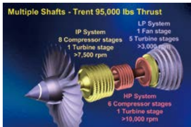
图3：三轴涡扇发动机剖视图
