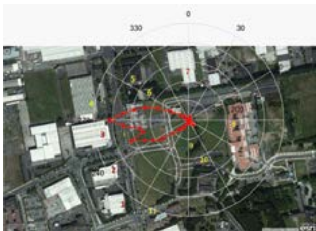
DKIT 分析复杂地形和障碍物对气流和风机运行的影响
